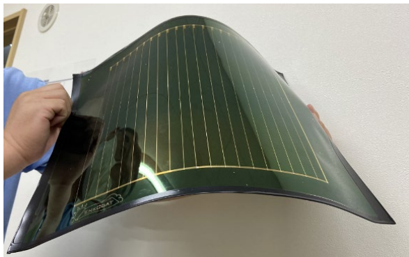
エネコートテクノロジーズが開発したペロブスカイト太陽電池
