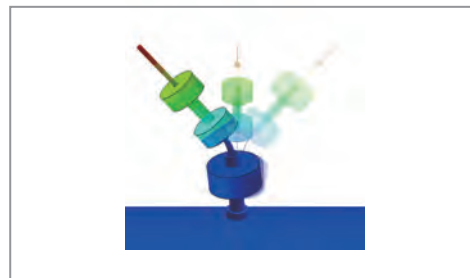
圧力計の振動応答の様子
