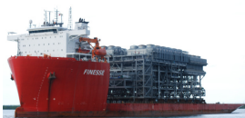
5,000トン超のモジュール運搬船
